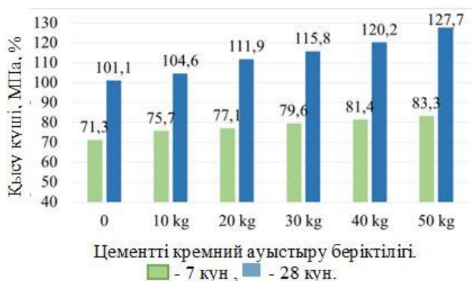
Сурет 2 - Микрокремний қосындылары бар үлгілердің сығымдалу беріктігі (авторлар материалы)
