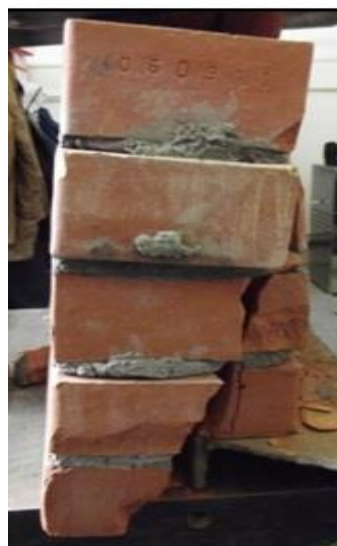
6-сурет – Кірпіш қалауды жергілікті сығуға сынау: а) сынаудың есептік сызбасы, б) кірпіш қалаудың қираған үлгісі (авторлардың материалы).
