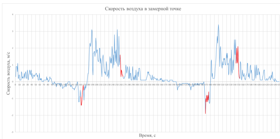
Рисунок 3 – Эксперимент по исследованию скорости и направления движения воздуха в вентиляционной сбойке на станции метро Студенческая Новосибирского метрополитена [материалы авторов]. a – схема станции с указанием места проведения замеров (точка 1), б – скорость воздуха в замерной точке
