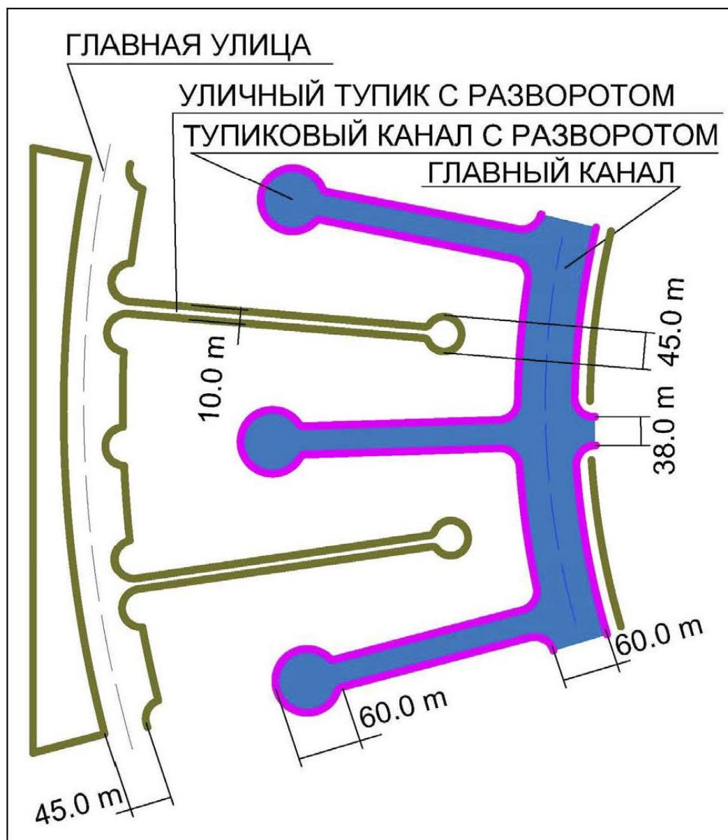
5-сурет – Нұра ауданында құрылып жатқан жол, су және кәріз желілеріне арналған шешімнің фрагменті (авторлар материалдары).
