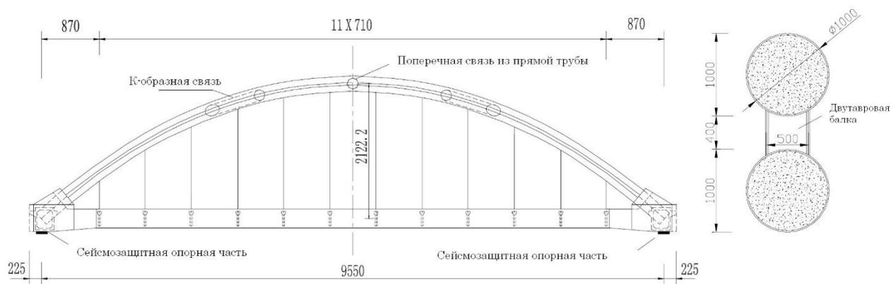
Рисунок 10 – Конструкция Второго моста через реку Хуанхэ в Чжэнчжоу. Размеры на фасаде указаны в см, на сечении – в мм (Zhang et al., 2004).
