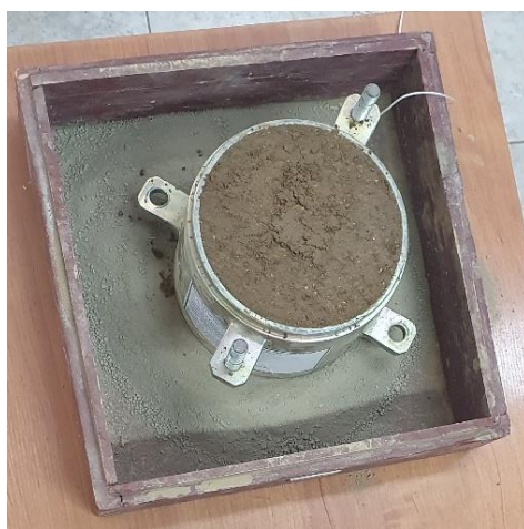
2-сурет – БЖҒЗО конструкциясының ПСУ стандартты тығыздау құралы (авторлық материал).
